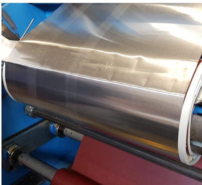
Avvolgimento di una bobina di alluminio a bassa tensione Winding of a low-voltage aluminium coil
