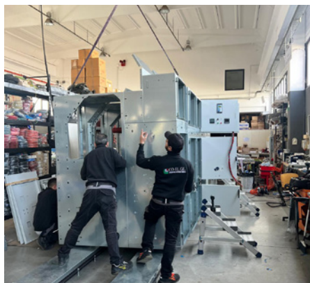
Assemblaggio quadri elettrici media tensione Assembly of medium voltage electrical panels
