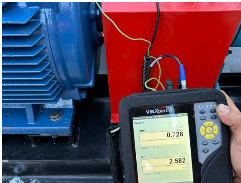
Analisi delle vibrazioni su generatori e motori Vibration analysis on generators and motors
