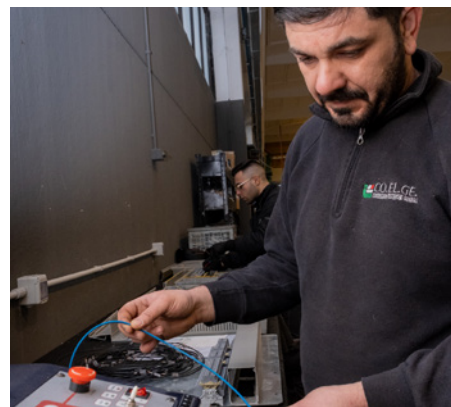
Sistema di taglio del filo di cablaggio Cable wire cutting system
